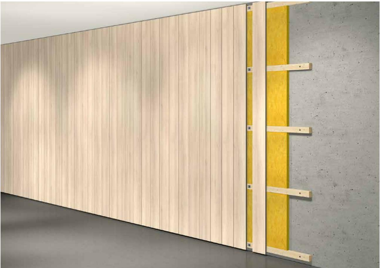
Vertikale Montage ohne Fugenversatz
