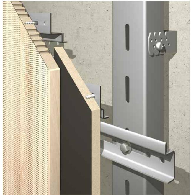
Detail vertikale Montage, Fuge hinterlegt
