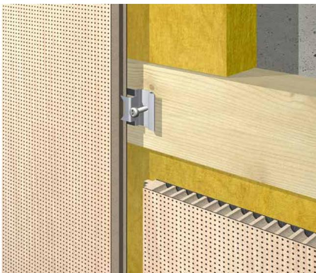
Detail vertikale Montage mit Montageclip
