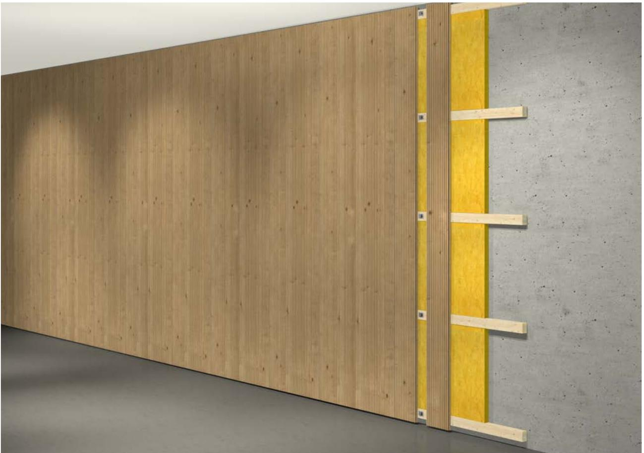
Vertikale Montage ohne Fugenversatz
