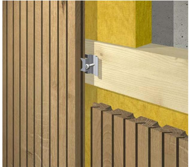
Detail vertikale Montage mit Montageclip
