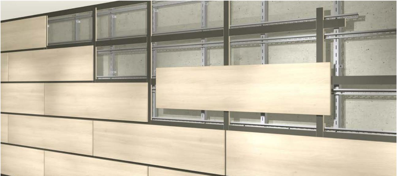
Horizontale Montage bei hinterlegter Fuge
