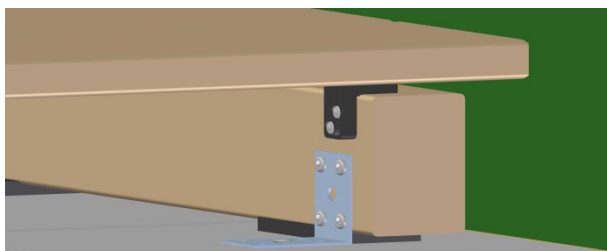
Bild 18. Montage Endclip an der Unterkonstruktion
