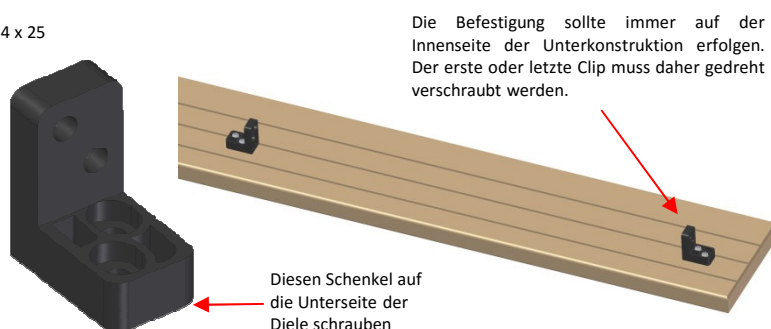
Bild 4. Übertragen Sie die Abstände der Unterkonstruktion.
