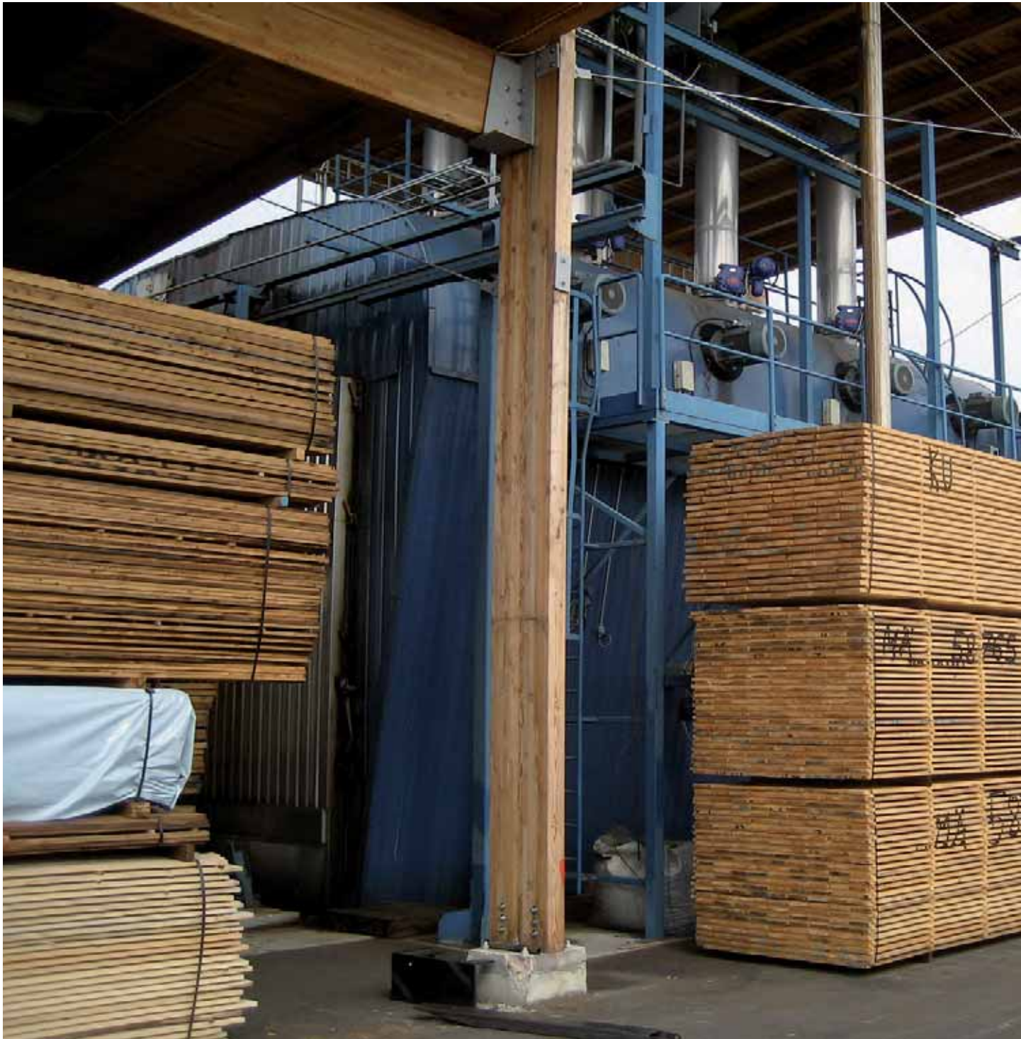
Anlage zur thermischen Modifizierung von Holz mit dem Fassungsvermögen von 60m 3
