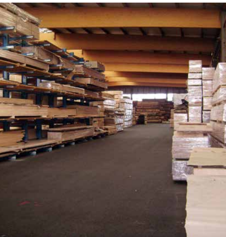
Blick in die Lagerung der Möbelbauplatten – Straße 2. Anbruchpakete werden im Kragarm, Originalpakete im Bulk-Lager vorgehalten.
