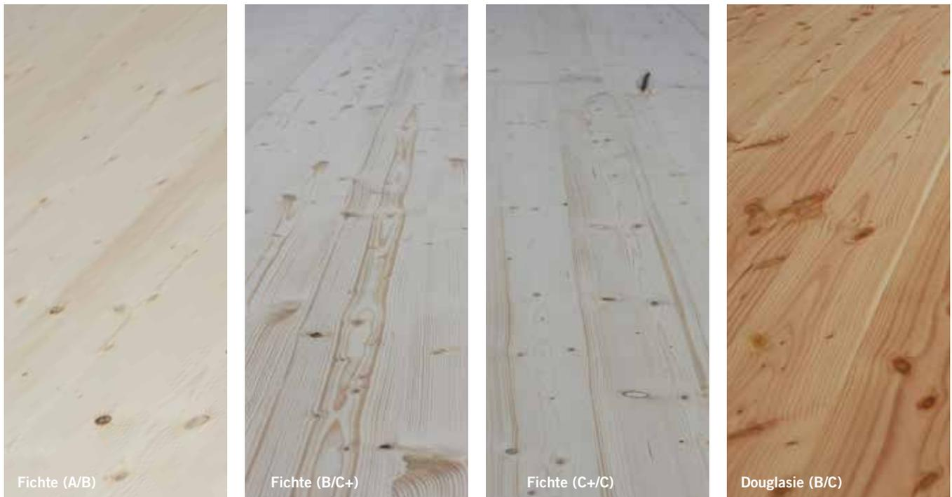
3-Schichtplatten bestehen aus drei Schichten Massivholz, bei denen zwei zueinander parallel laufende Deckschichten mit einer um 90° versetzten Mittellage verleimt sind. Dadurch erreichen diese Platten ihre hohe Formstabilität. Durch die fugendichte Verleimung der durchgehenden Einzella-mellen der Deckschichten entsteht ein sehr natürliches Erscheinungsbild.
