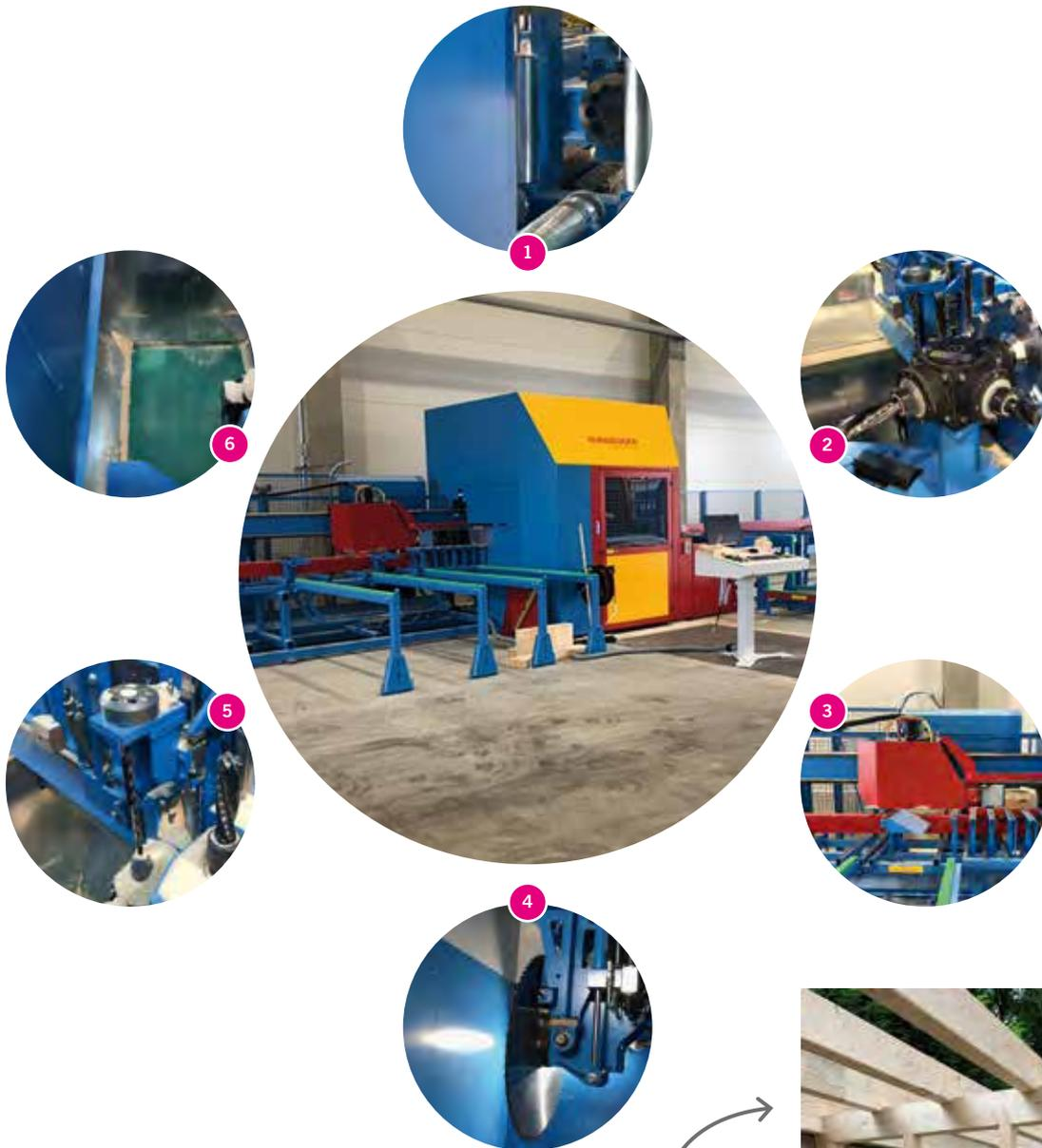
**Schritt 1:** Horizontal Bohrergeräte
