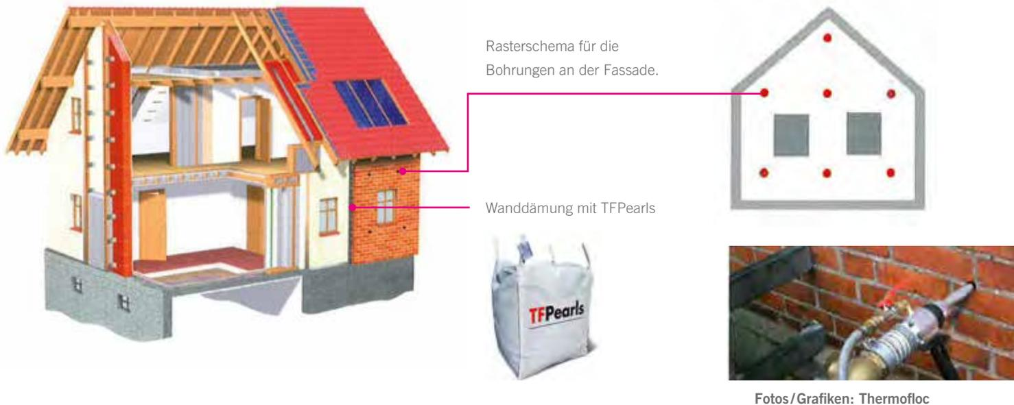
Zum Anbringen von THERMOFLOC TFPearls werden alle 1,2–1,8 m Bohrungen mit einem Durchmesser von 25 mm an der Kreuzung von Stoß- und Lagerfugen in einem festen Raster angebracht.
