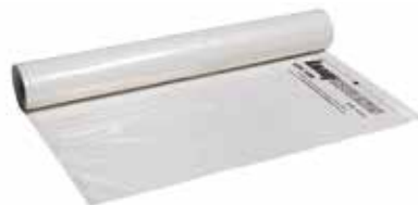
Knauf Insulation LDS 100 Stark diffusionshemmende Dampfbremsbahn s_d -Wert: 100 m Flächengewicht: 185 g/m 2 (± 7 %)
