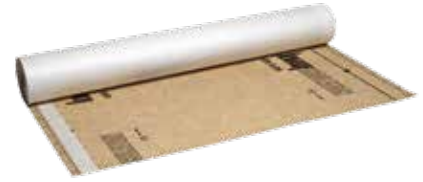
Knauf Insulation LDS 0.04 Diffusionsoffene Unterspann-/Unterdeckbahn. s_d -Wert: 0,04 m Flächengewicht: 150 g/m 2 (± 10 %)
