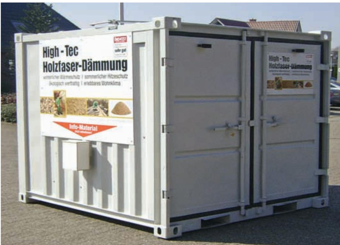
Der Zellofant wird direkt auf die Baustelle geliefert. In dem robusten Baucontainer sind alle notwendigen technischen Geräte enthalten, um einen reibungslosen und schnellen Ablauf der Einblasmontage auf der Baustelle zu gewährleisten.
