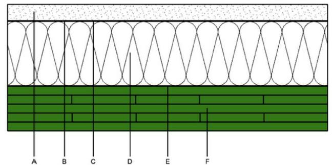
*Baustoffangaben zur Konstruktion, Schichtaufbau (außen nach innen)*
