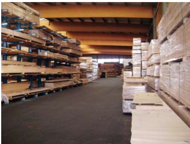
Blick in die Lagerung der Möbelbauplatten – Straße 2. Anbruchpakete werden im Kragarm, Originalpakete im Bulk-Lager vorgehalten.
