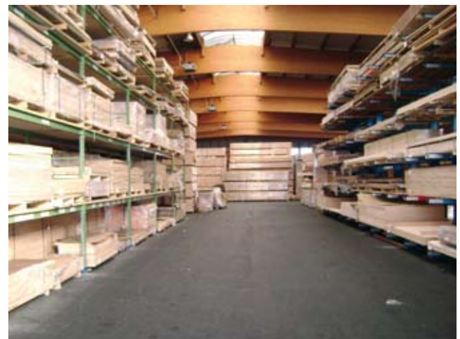
Blick in die Lagerung der Möbelbauplatten – Straße 2. Anbruchpakete werden im Kragarm, Originalpakete im Bulk-Lager vorgehalten.
