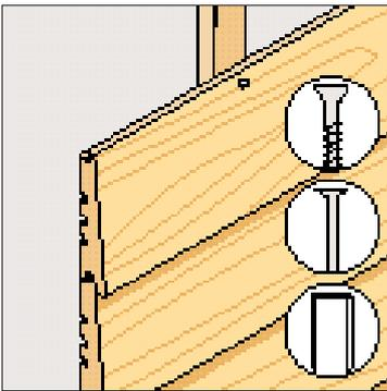
Das **Variantprofil** wird unsichtbar durch die Nagelfuge montiert. Es kann geschossen, geschraubt oder genagelt werden.
