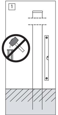
**Achtung:** Verwenden Sie bei dem Elephant Eck-Beschlagset jeweils einen Beschlag mit runden Löchern zur Montage oben am Zaun. Die vier Beschläge mit den ovalen Schlitzern dienen für die mittlere und untere Befestigung des Zauns. Verwenden die immer zwingend sechs Beschläge pro Zaun! **Dieser exklusive Gartenzaun ist für die Anwendung der Lamellen in horizontaler Lage (siehe Abb.) konstruiert.**
