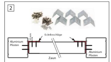
**Wichtig:** Ziehen Sie die Schrauben der obersten zwei Beschläge mit runden Löchern fest an. Die anderen vier Beschläge (Mitte / Unten) müssen nicht komplett fest angezogen werden. Platzieren Sie die Schrauben im unteren Bereich der Schlitzte um eventuelles Arbeiten des Zauns aufzufangen. Halten Sie jeweils unter und über dem Zaun einen Freiraum von 2cm.
