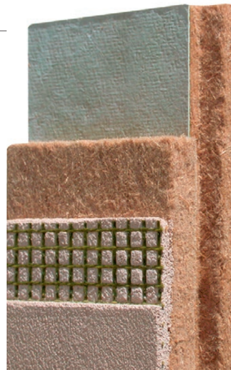
Die Pavadentro-Innendämmung aus Holz-faser nutzt die kapillare Leitfähigkeit und die hygroskopischen Eigenschaften von Holzfasern und beugt so einer zerstörenden Kondensatbildung vor.
